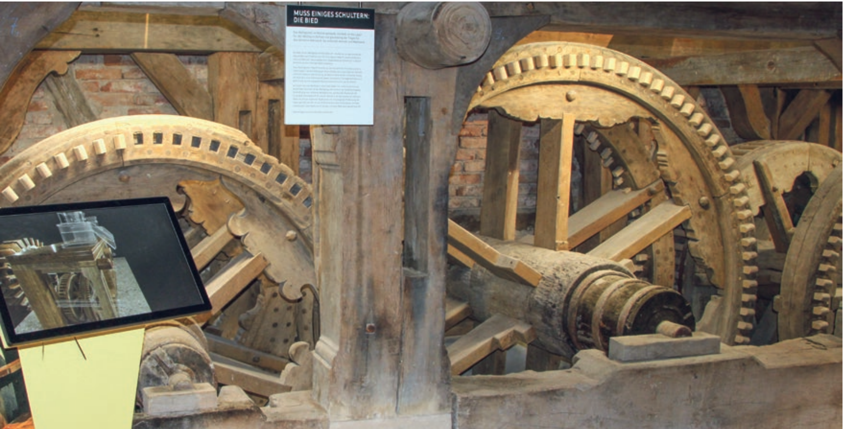
Das Mühlgestell, die sogenannte Bied, sitzt in der Mühle an zentraler Stelle zwischen Antrieb und Mahlwerk. Foto: Christine Berger
